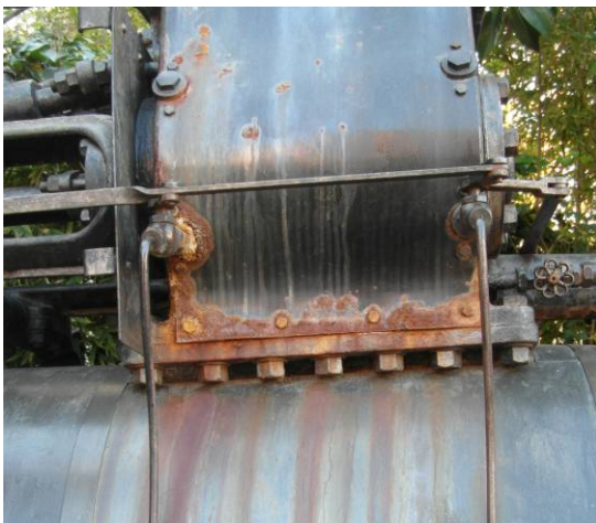
Detall de l'òxid de la piconadora abans i després de restaurar
