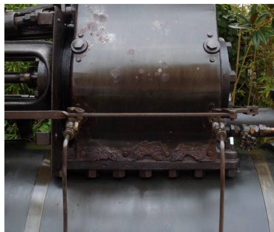
Detall de l'òxid de la piconadora abans i després de restaurar
