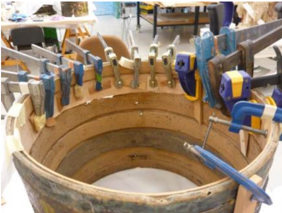
Procés de reforç i correcció de la deformació. Fotos: Joan Escudé
