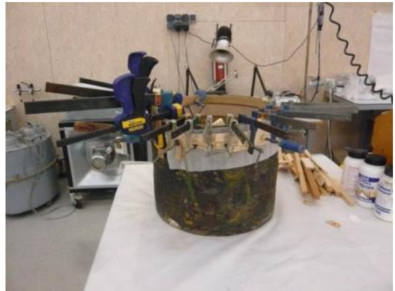
Procés de reforç i correcció de la deformació. Fotos: Joan Escudé
