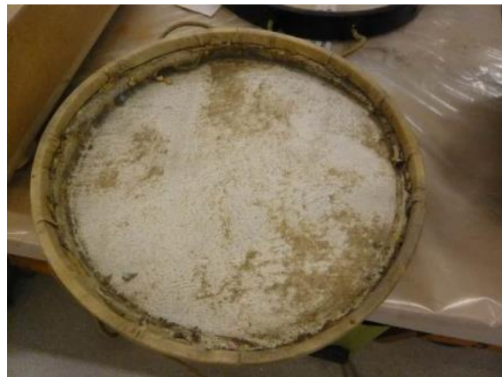
Procés de desencordat i dipòsits superficials de brutícia a l'interior de les membranes. Fotos: Joan Escudé
