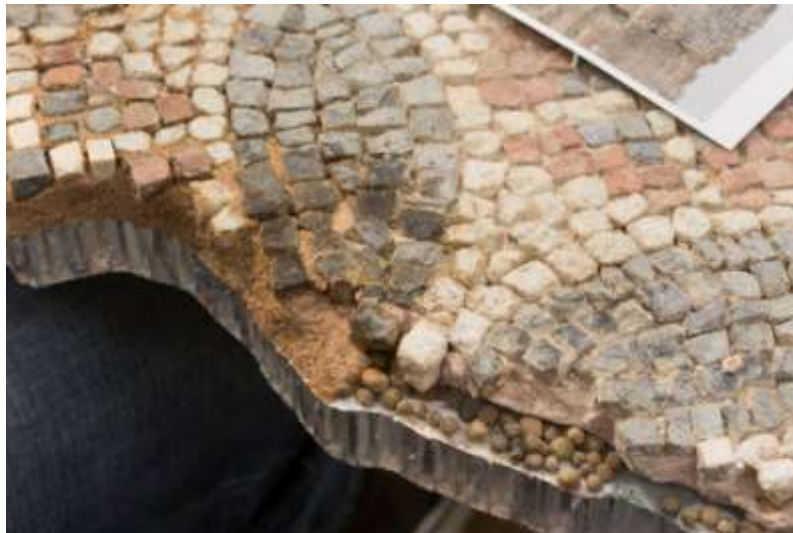
Estratigrafia del muntatge del mosaic. De baix a dalt: panell de suport adhesiu (Hexlite®), àrid lleuger (Arlita®) i morter de calç
